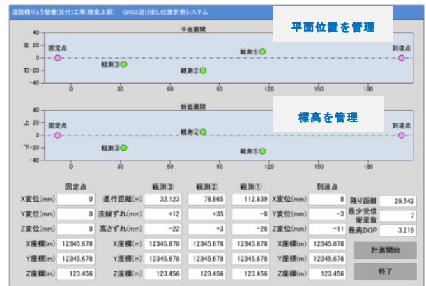
図3 送出し位置計測システムの概要
