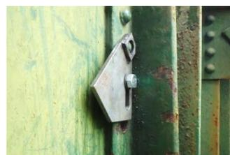
写真7 孔明け機専用治具
