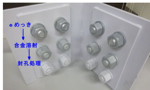
写真 3 二重防錆ボルトの施工手順
