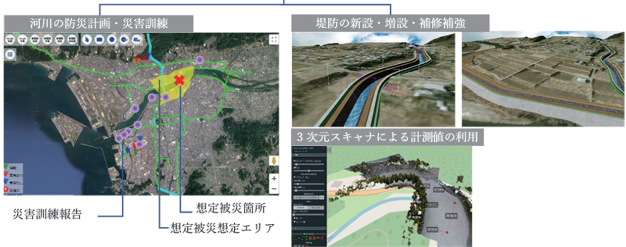
図7 堤防・河道設計における BIM/CIM
