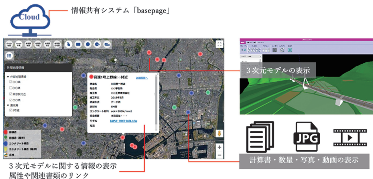
図9 BIM/CIMにおける情報流通基盤
