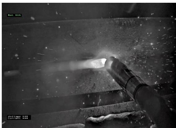
写真3 溶接部可視化システムで撮影した溶接部
