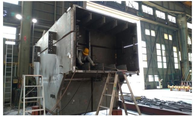
写真 1 橋梁部材製造の様子
