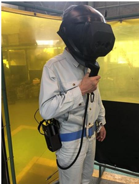
写真 6 次世代 3D 溶接部可視化マスクの装着の様子
