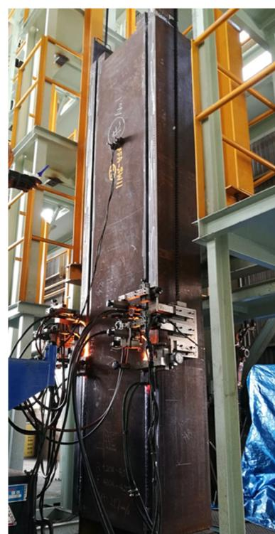
写真 1 エレクトロスラグ溶接法による施工の様子
