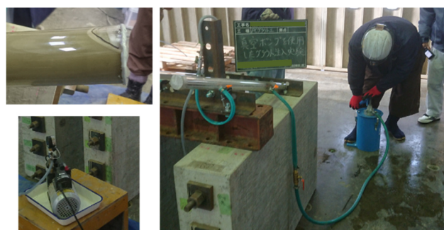
写真11 グラウト注入実験状況(真空ポンプ)
