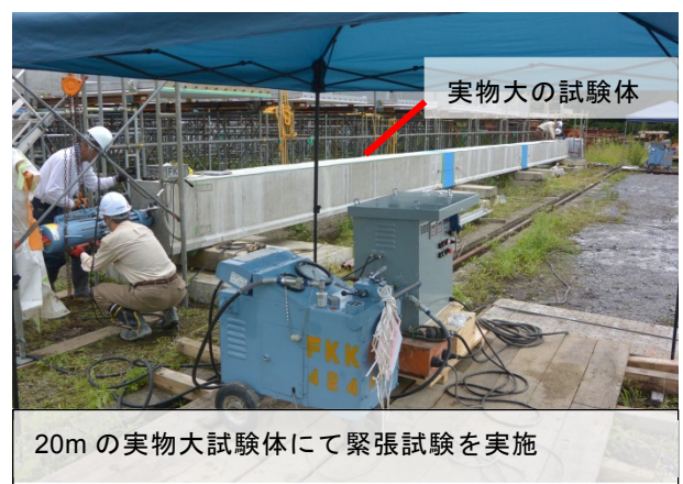
20m の実物大試験体にて緊張試験を実施
