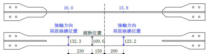
図 12 KBL8M52G 試験体の芯材寸法（解体後）
