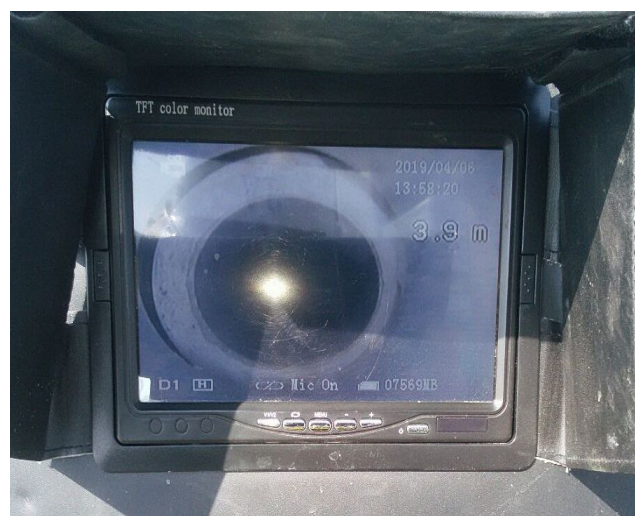
写真13 ファイバースコープ漏出確認
