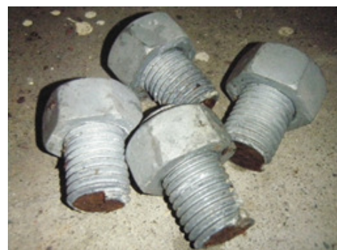
写真2 破断した連結ボルト
