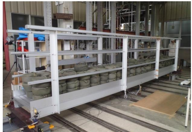
写真2 アルミ検査路静的載荷試験
