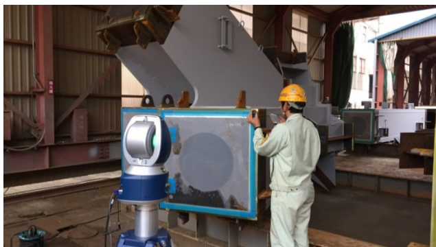
写真2 レーザートラッカーの使用時
