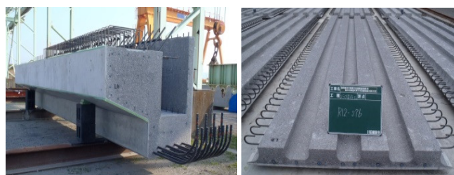
c) 端横梁 d) PCa スラブ 写真 1-2 ハーフプレキャスト部材
