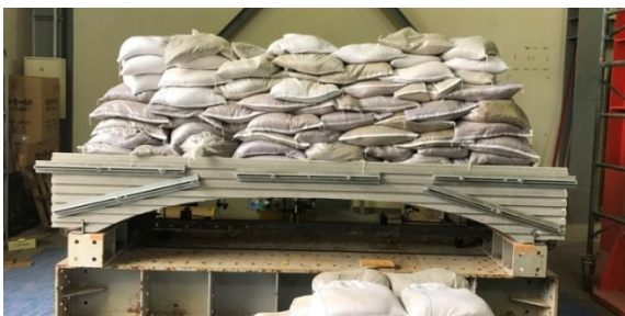
写真2 砂荷重等分布荷重状況
