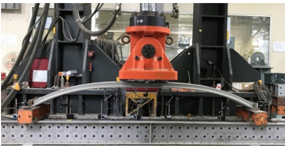
写真1 中央点集中荷重状況
