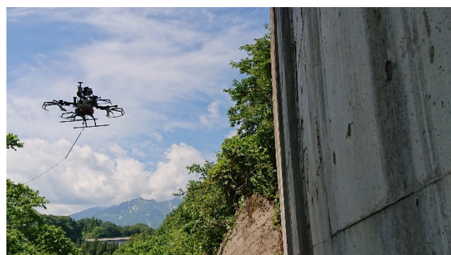
図1 自動間隔制御での飛行：橋脚から一定間隔を維持
