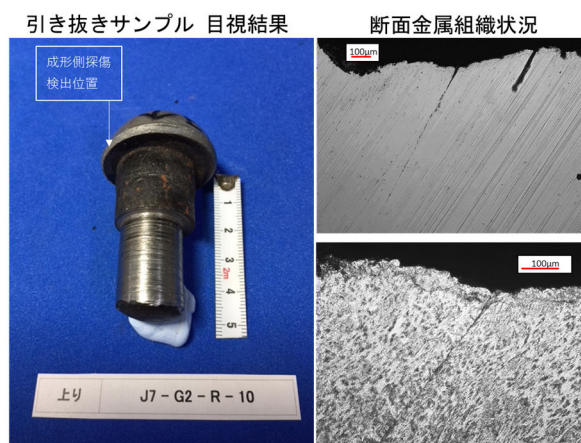
写真 11 リベット引き抜きサンプルと断面金属組織
