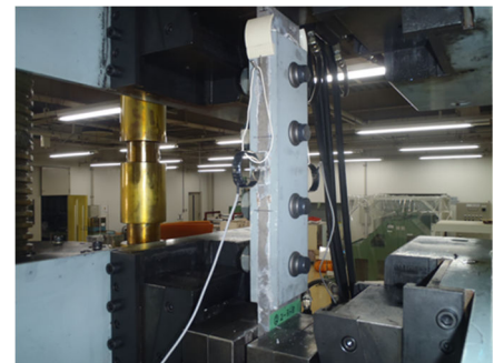
写真 9 ワンサイド高力ボルトすべり試験
