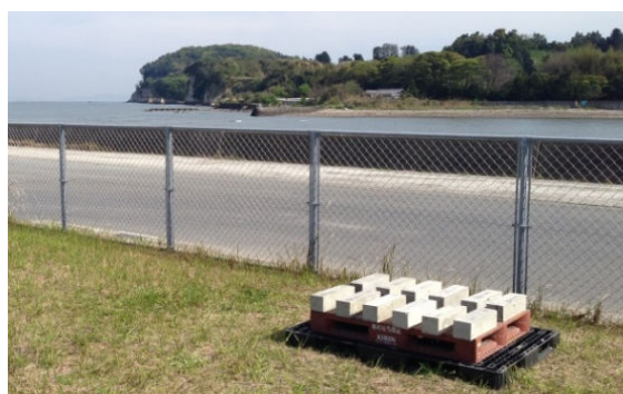
写真 3 角柱供試体の暴露状況
