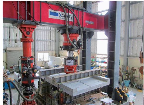
写真2 押抜きせん断耐力試験状況
