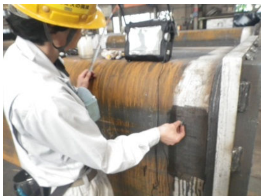
写真1 UT検査作業
