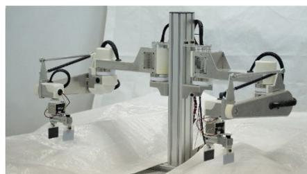
写真2 試作した小型軽量双腕ロボット単体の全景
