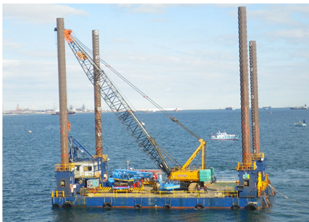
写真11 自己昇降式作業台船 (SEP 船) 外観
