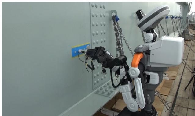
写真 6 塗装膜厚測定
