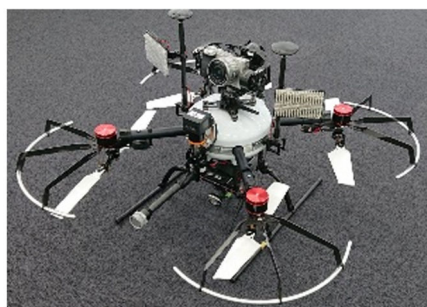
写真 1 照明装置を搭載したドローンの外観写真
