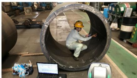
写真2 レーザートラッカーでの測定状況
