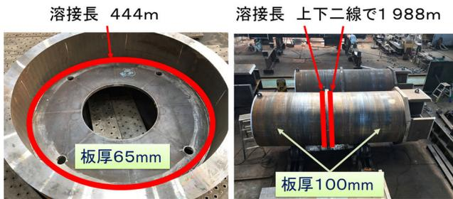
写真1 溶接量の算出
