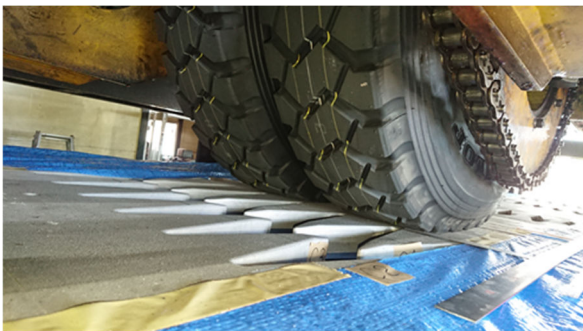
写真2 KMA-230の輪荷重走行試験
