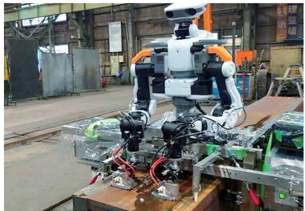
写真5 「NEXTAGE」による両手探傷状況
