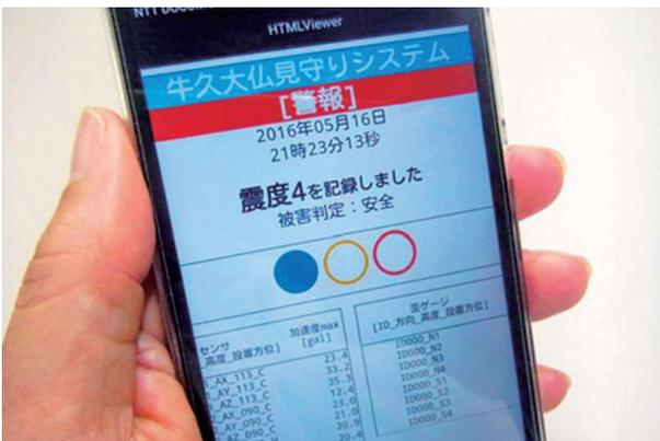
写真21 運用中の構造ヘルスマモニタリングシステム
