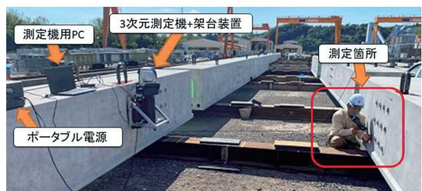
写真15 3D次元測定器+架台装置の全体
