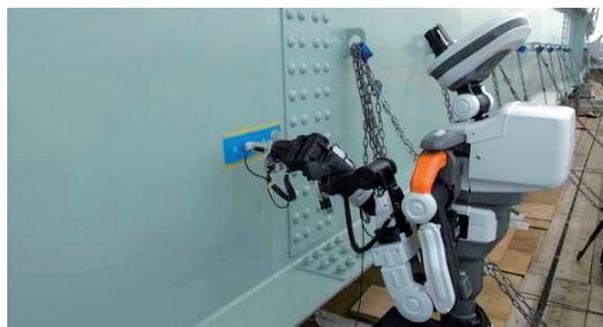
写真 13 塗装膜厚測定
