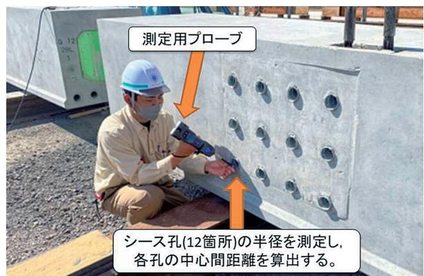
写真16 プローブによる計測状況
