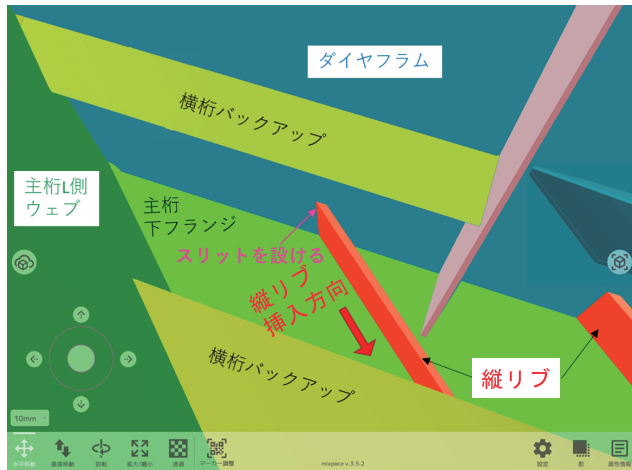
写真6 MRによる溶接作業性の確認
