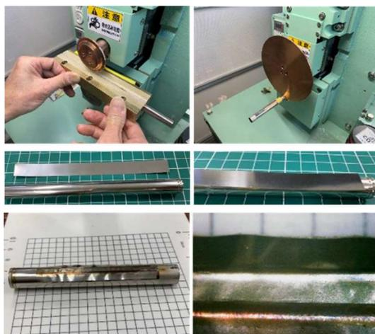
図 16 水素分離膜のシーム溶接
