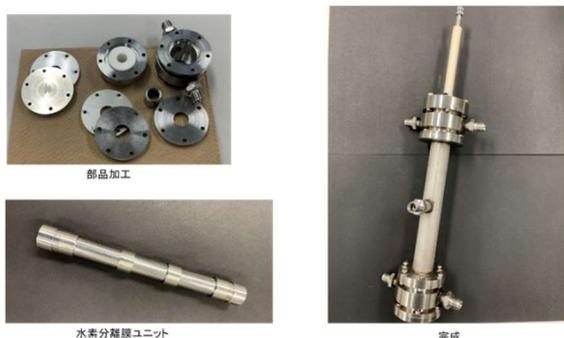
図 17 開発した水素分離膜組込リアクター
