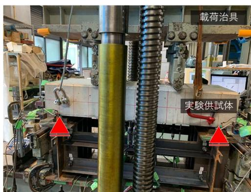
図 3 曲げ載荷実験時の様子 (SB-2)
