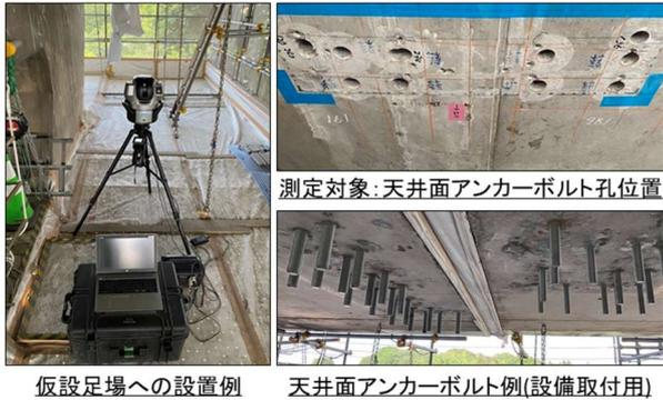
図 4 アンカーボルト孔位置の測定（高速道路 PC 桁上部工）
