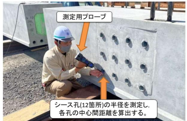
図 7 3次元測定機+架台装置を用いた測定状況(測定箇所)
