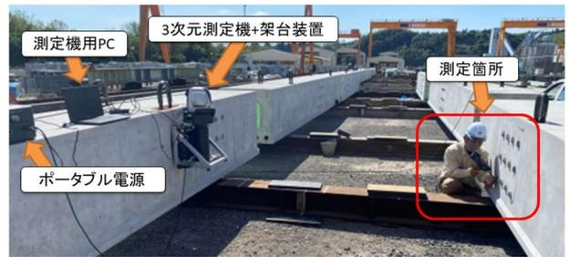
図 6 3次元測定機+架台装置を用いた測定状況(全体)
