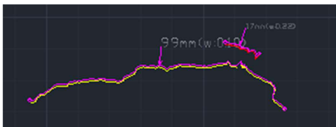
写真 4 ひび割れ DXF データ画像
