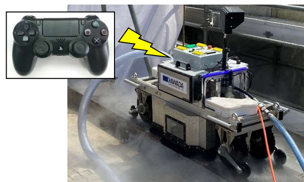
写真 2 鋼桁ケレン装置本体（試作 2 号機）
