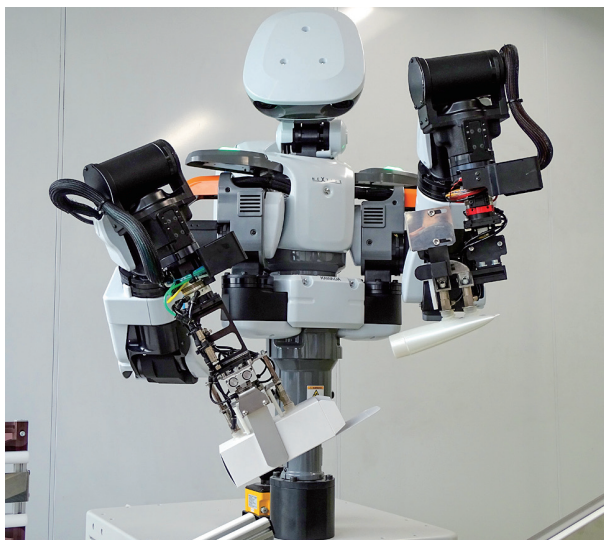
写真4 梱包箱組み立て・箱詰めシステム「Cobako（コバコ）」
