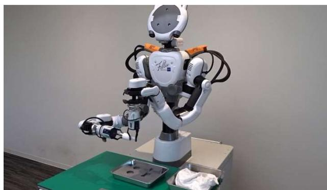
写真 2 障害物除去後の組立工程への復旧
