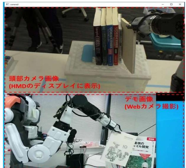
写真3 遠隔操作による本ピックアップ
