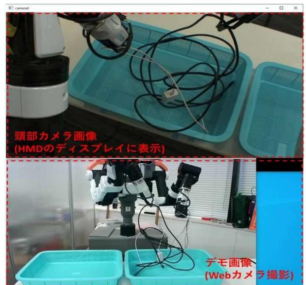
写真4 遠隔操作によるケーブルピックアップ
