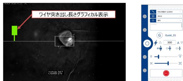
図2 溶接中のワイヤ突き出し長さ表示画像と アプリケーション画面
