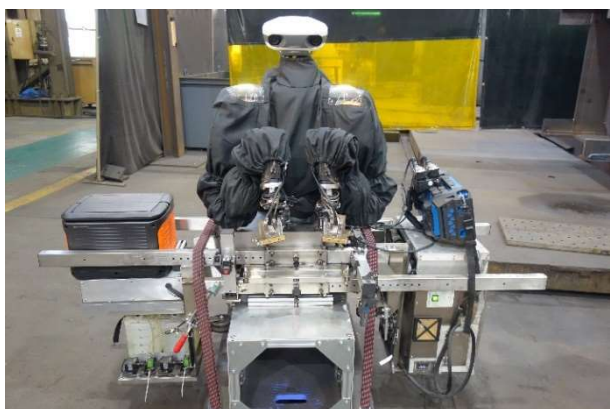
写真4 NEXTAGE 搭載自動探傷装置
