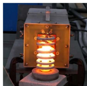
写真 5 高周波誘導加熱状況
