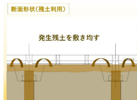
図1 発生残土を敷き均し全体的に盛り上げる
