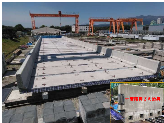
写真2 壁高欄一体型プレキャスト PC 床版
