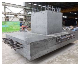
写真2 免震上部基礎部材
