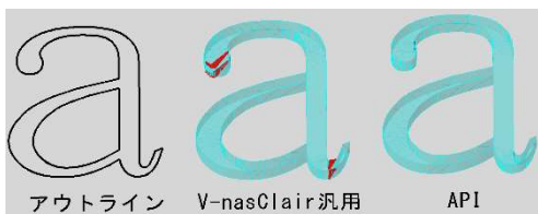
図4 押出形状作成例（赤はエラー部）
