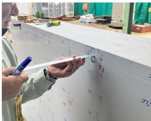
写真 8 側鋼板の変形量の計測
