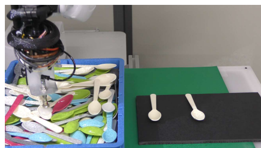
図 6 バラ積みピッキング
