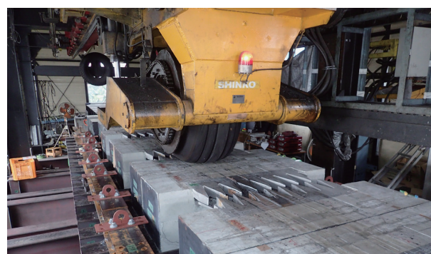
写真2 輪荷重走行試験の様子 9)
