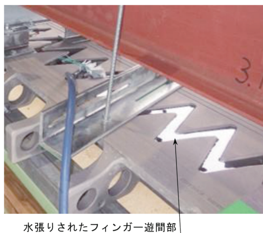
図4 工場出荷製品に対する水張試験
