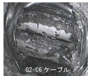
写真 3 腐食なし (健全度 0)
