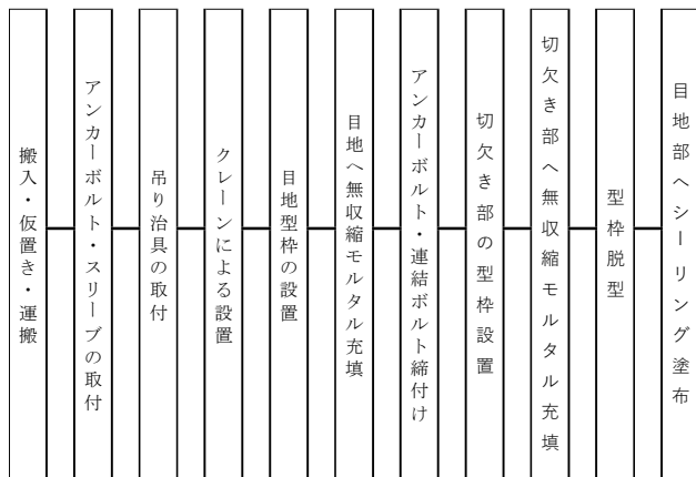
図10 プレキャスト壁高欄施工フロー
