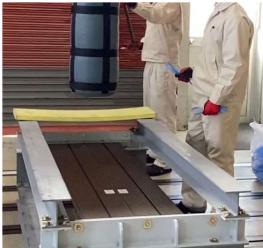
写真3 裏面パネルの衝撃載荷試験の様子
