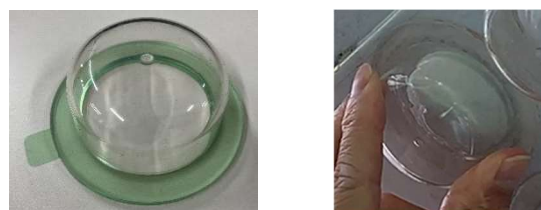
図3 キャップ用テープと接着状況
